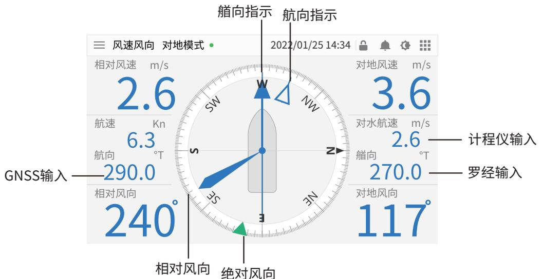
注:绝对模式和对地模式中,对水航速如没有计程仪数据,则使用GNSS中的航速;船向如果没有罗经输入,则取GNSS中航向数据进行计算。如果未接入数据,则对应的数据则无法计算。
